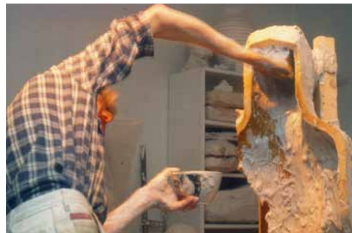
Første gang gips kastes på med hånden. Lærredstykker af passende størrelse dyppes og trykkes mod gipsen. Formdelene samles indvendigt med sækkevæv dyppet i gips, den sidste del limes på/trykkes ned i gips, som er så tilpas hærdet, at den har konsistens som flødeskum.
