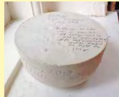
Gipsobjekt som har præcis 1 liters rumfang, støbt i en gummikop med 1000 g gips og 600 g vand for at undersøge forholdet mellem vand og gips.
