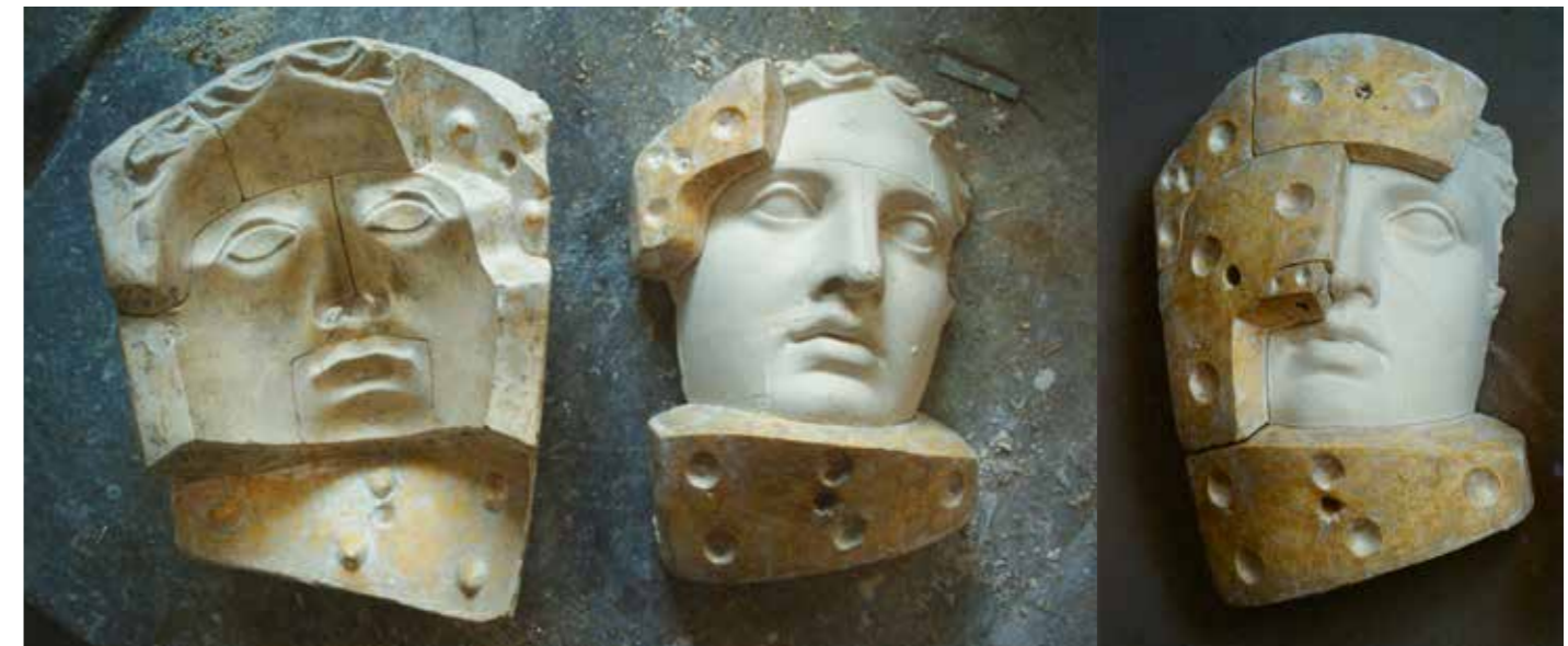
I kilestykkerne indstøbes som regel et ståltrådsoje, således at man under støbningen, gennem et hul i hovedstykket, kan fastgøre dette med sejl garn.
