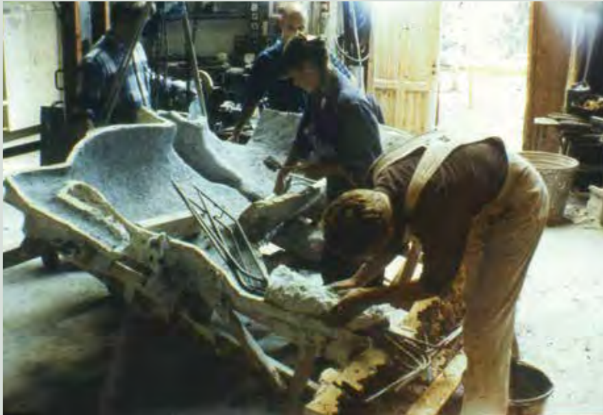
Rytterstatue i beton af Ole Barslund (1968-) — Rytterstatuen blev modelleret i ler og støbt i fiberbeton af Ole Barslund i 1994, mens han var elev på Billedhuggerskolen. Den blev støbt i fiberbeton i en uægte gipsform. Hestens krop blev støbt som en skal i fiberbeton. Den vejede ca. 500 kg og blev båret af de tre bærende ben – ca. 10-15 cm tykke på det tyndeste sted – som blev armeret med 10 omhyggeligt placeret riflede 10 mm rustfri rundstål. Soklen, som var næsten massiv, vejede også ca. 500 kg.
